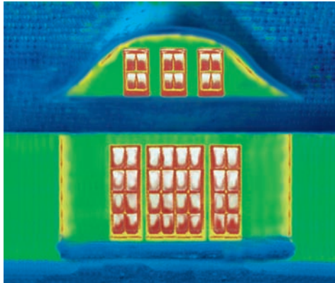
Før renovering: Gamle trævinduer, hvor der går meget varme til spilde (røde felter på foto).
